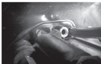
Racordement de la durite à la pièce FB03039 Connexion between tube and FB03039
